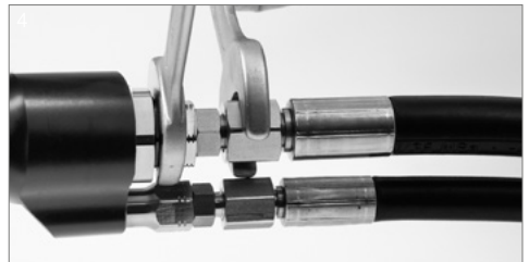
4 Schlauchleitungen an Zapfventil anschrauben. Sofern nicht anders vom Schlauchleitungshersteller angegeben, Fülleitung mit 45 Nm und Entlüftungsleitung mit 35 Nm anziehen. Kein Einsatz von Zangen oder Rohrzanzen.
