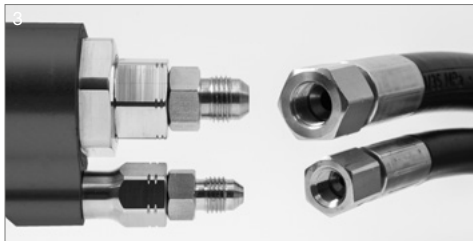
3 Anschlüsse müssen in Typ und Größe übereinstimmen, z.B. JIC 37° 9/16"-18 AG / IG
