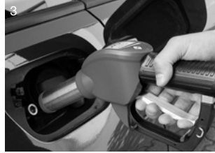
Zapfventil aus der Zapfsäulenhaltung nehmen und Kupplungsgarnitur am Füllstutzen ausrichten.
