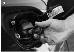
Alle Kupplungsteile, Dichtungen und Dichtflächen des Zapfventils und Füllstutzen des Fahrzeugs auf Beschädigungen und Sauberkeit prüfen.
