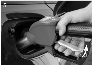
In dieser Position bleiben und Schalthebel ziehen.
