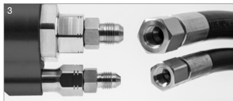
Vérifier si les connexions correspondent en terme de type et de taille, par ex. JIC 37° 9/16-18" mâle/ femelle
