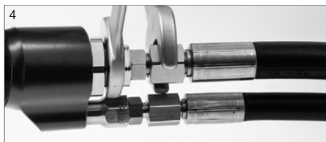
Connectez les flexibles au pistolet. Serrez la ligne de remplissage à 45 Nm et la conduite d'évent à 35 Nm ou selon le couple de serrage recommandé par les fournisseurs des raccords des flexibles. N'utilisez pas de pince.
