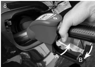
Wenn Tankvorgang beendet ist, Schalthebel ziehen (A) und loslassen (B). Die Aufhaltefunktion ('Aufrasten') wird dabei automatisch deaktiviert.
