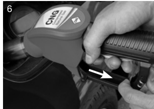
Schalthebel gezogen halten und Aufhalteraste feststellen, um das Ventil zu öffnen. Nach Loslassen des Hebels verbleibt dieser in der 'Auf'-Position.
